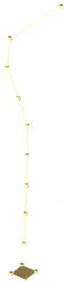
Rys. 34 Postać drgań 2, częstotliwość 9.27 Hz, tłumienie 0.16%
