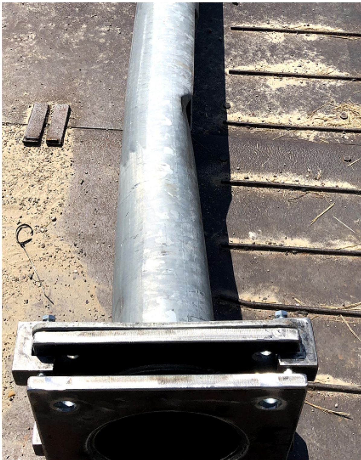
Rysunek 8. Słup bezpieczny typu LE przed i po badaniu
