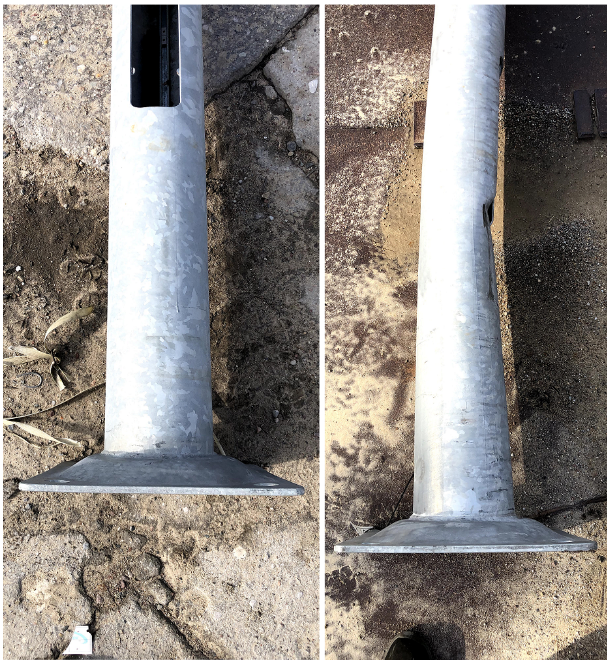
Rysunek 7. Słup bezpieczny typu LE przed i po badaniu
