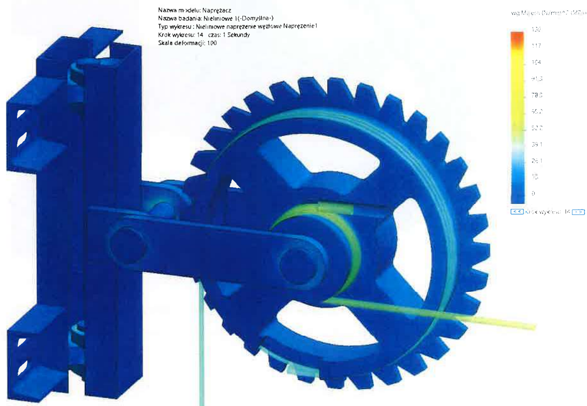
Rys. 17 Symulacja warunków eksploatacji napinacza – rozkład naprężeń zredukowanych (wg hipotezy Hubera-Misesa)
