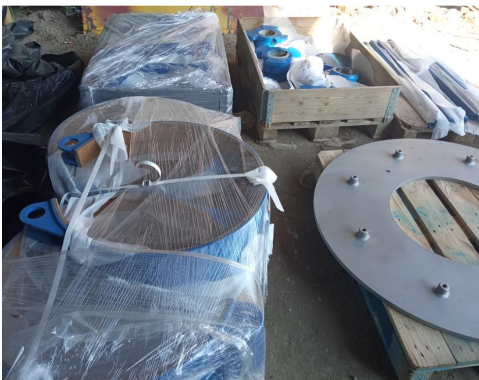
Rysunek 21 Mniejsze podzespoły po malowaniu, obejmy hamulcowe z przeklejanymi ferrodami ciernymi
