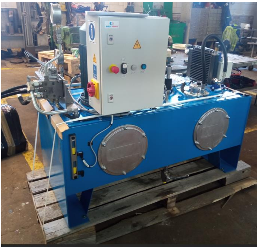
Rysunek 29 Agregat hydrauliczny skonfigurowany do testów wciągarek
