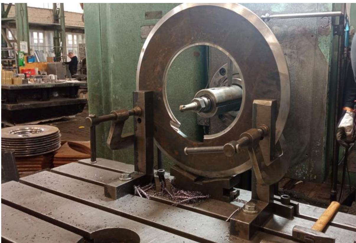
Rysunek 11 Wstępna obróbka policzków do bębnow linowych
