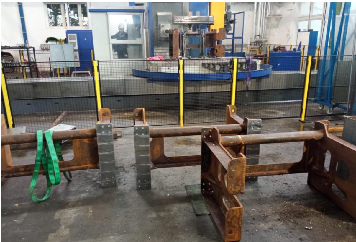
Rysunek 12 Obróbka na gotowo ram głównych
