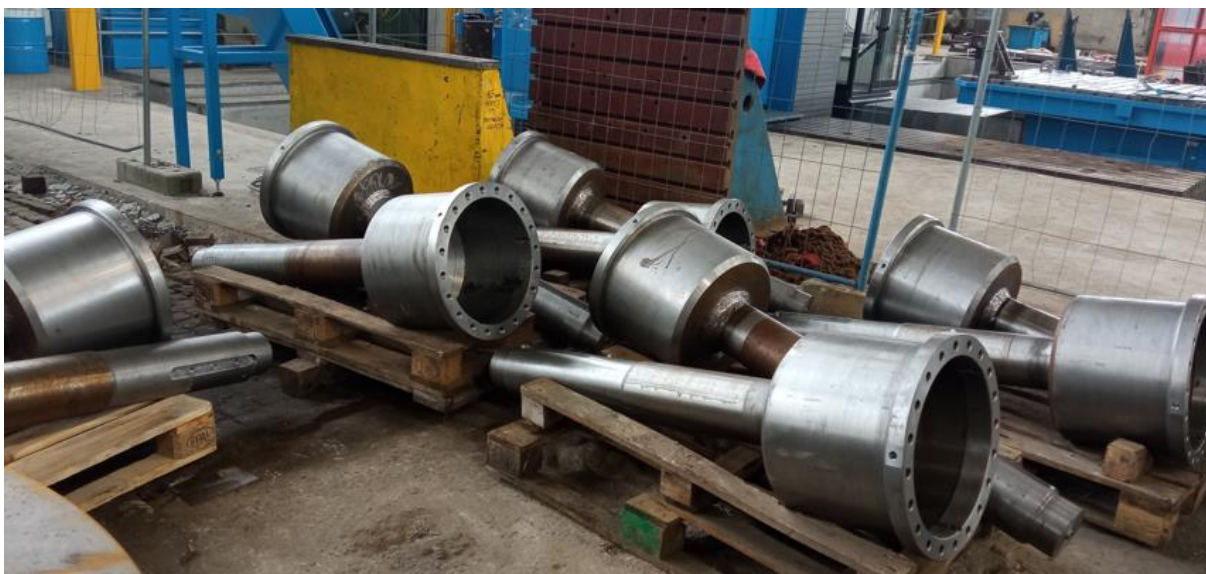
Rysunek 10 Seria wałów głównych w trakcie obróbki
