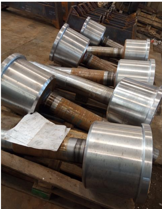
Rysunek 9 Seria wałów głównych w trakcie obróbki
