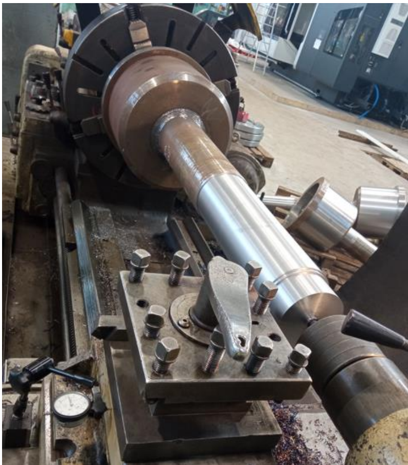
Rysunek 7 Wał główny w trakcie obróbki na tokarce
