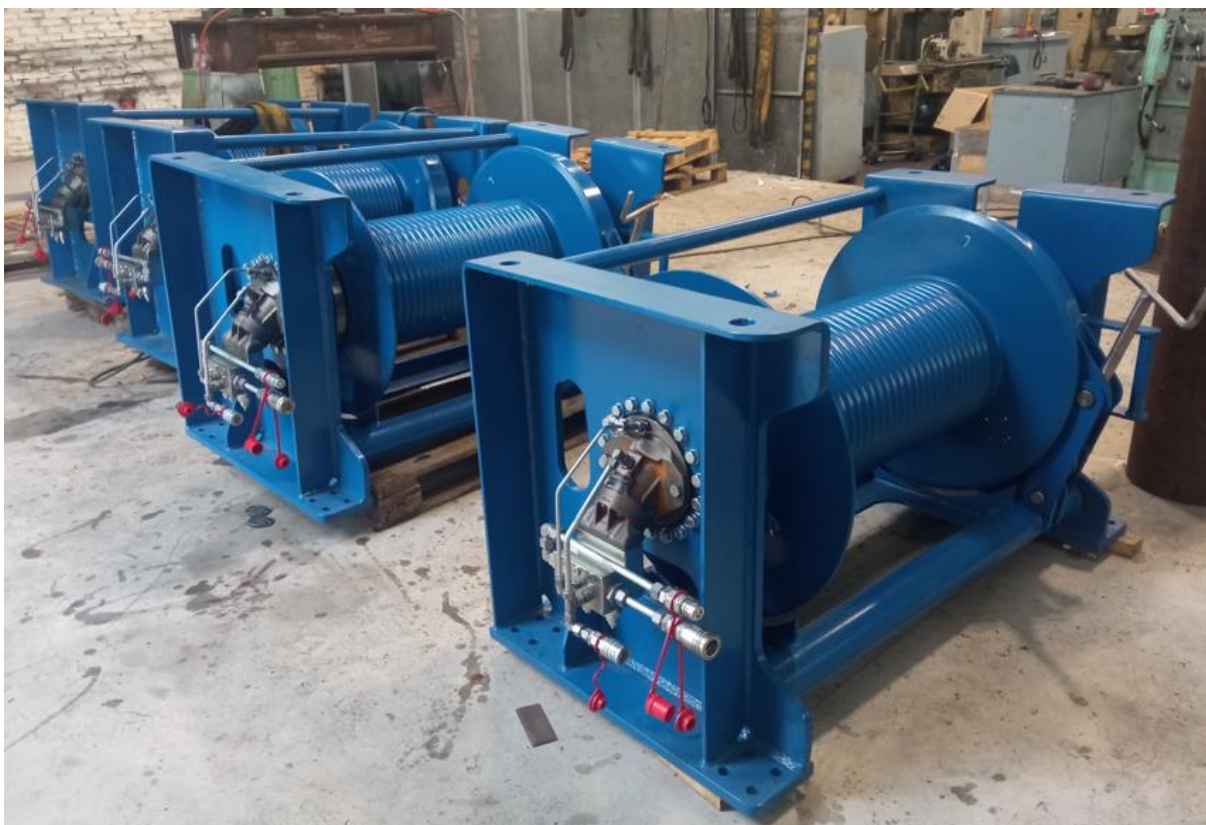
Rysunek 28 Windy 10T z zamontowanymi przyłączami hydraulicznymi
