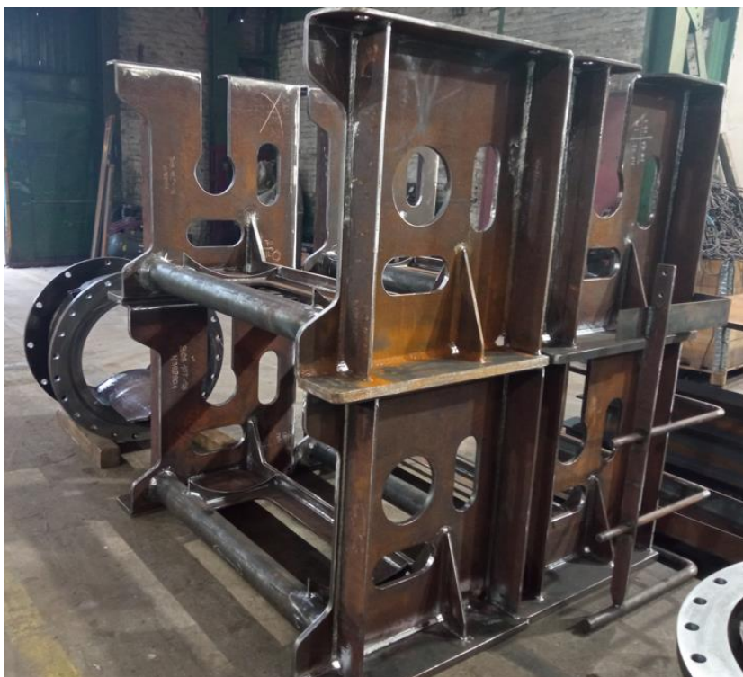
Rysunek 6 Seria ram głównych wciągarek po montażu i spawaniu
