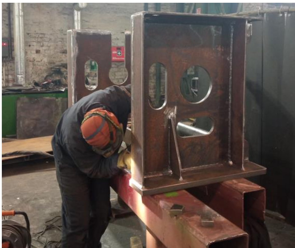
Rysunek 5 Prace związane z montażem i spawaniem ram głównych dla wciągarek 10T
