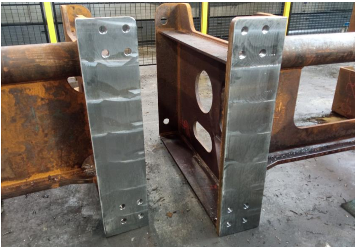
Rysunek 14 Stopy ram głównych po obróbce skrawaniem
