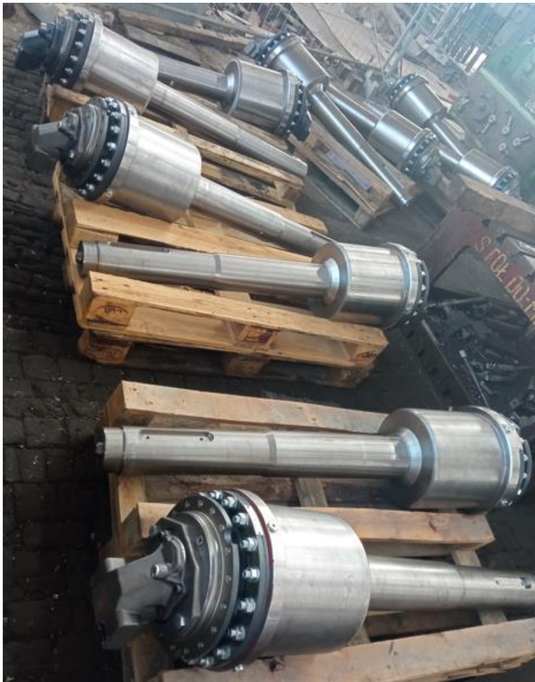
Rysunek 23 Montaż przekładni w pochwy wałów głównych
