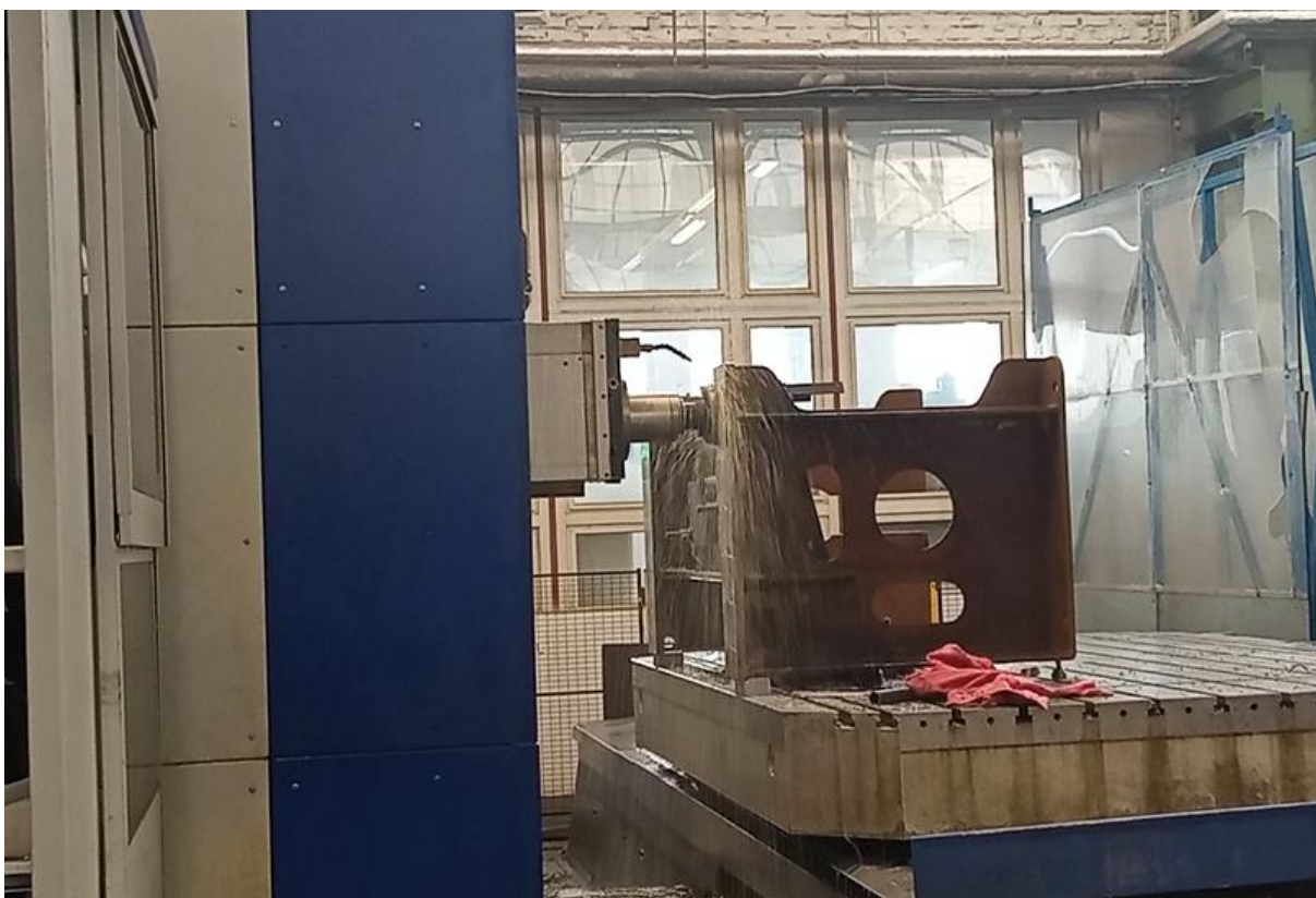
Rysunek 13 Ramy główne w trakcie obróbki
