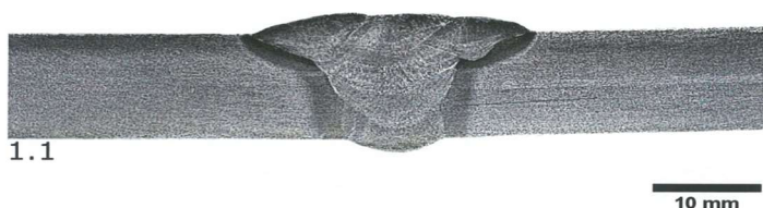
Rysunek 16 Makrostruktura złącza próbnego
