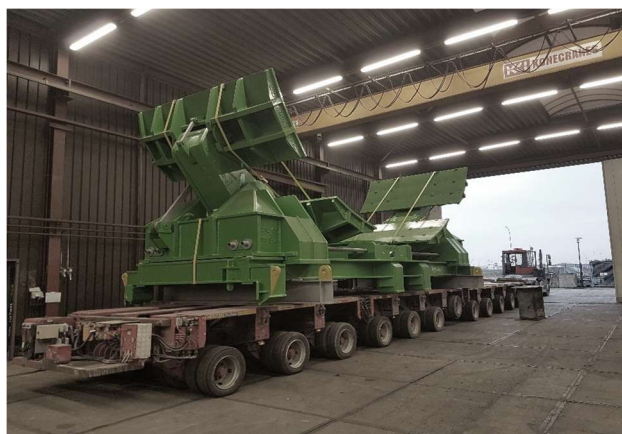
Rysunek 23 Konstrukcja typu Cradle przed próbami przy dużych przeciążeniach
