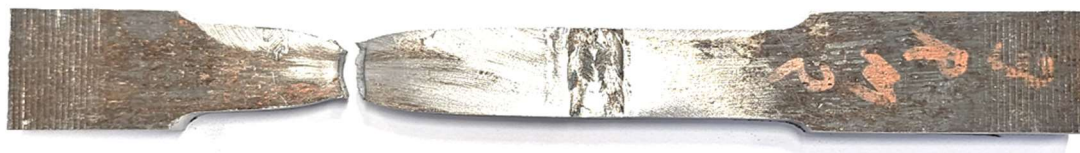
Rysunek 17 Próbką po statycznej próbie rozciągania złącza próbnego
