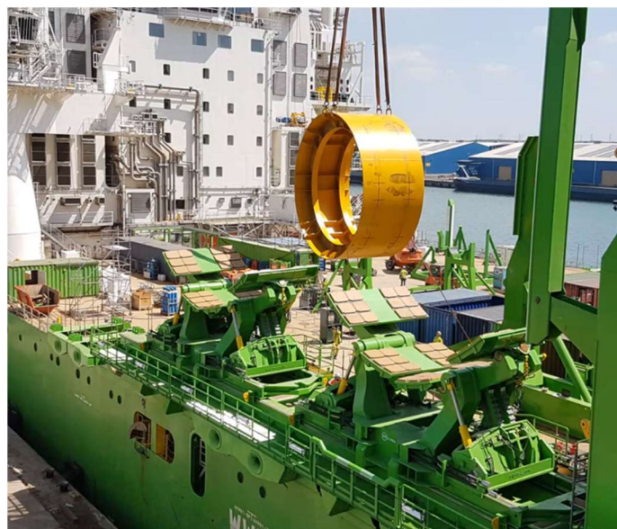
Rysunek 23 Próby obciążeniowe pod ciężarem rzeczywistego elementu morskich wież wiatrowych
