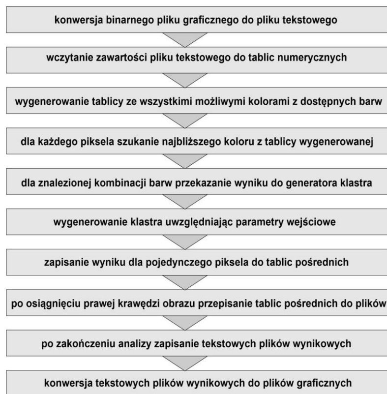
FOTO. Schemat logiczny programu do obsługi głowicy E.
