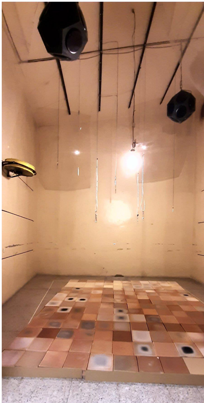
FOTO. Badanie sztywnych, ceramicznych pochłaniaczy dźwięku w komorze pogłosowej AGH w Krakowie.
