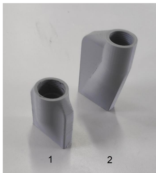
FOTO. Dysze obrotowe prototyp w technologii wydruku 3D. 1- dysza prosta oś obrotu w środku przekroju roboczego, 2- dysza prosta z osią obrotu na krawędzi roboczej przekroju.
