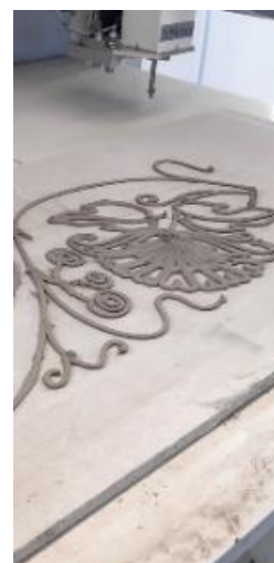
FOTO. Interfejs do druku paneli elewacyjnych z widoczną trajektorią ruchu, próbka wydruku panela dekoracyjnego.
