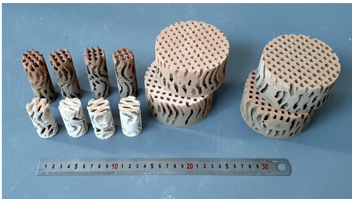
FOTO. Próbki struktur „kratka” i „fala” z kanałami o przebiegu helisy wydrukowane akustycznymi masami ceramicznymi.
