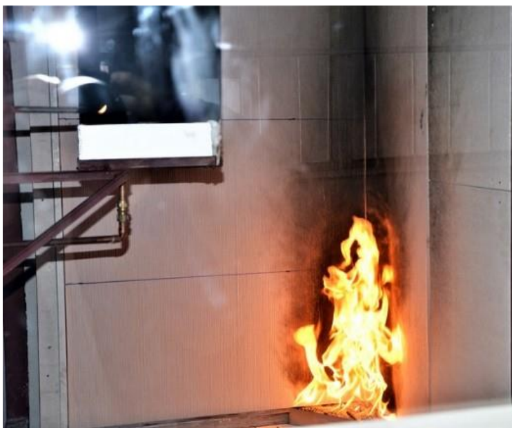
FOTO. Badanie próbek nr 1, 2, 3 na reakcję na ogień zgodnie z normą PN-EN 13823 dla klasy A2-s1,d0
