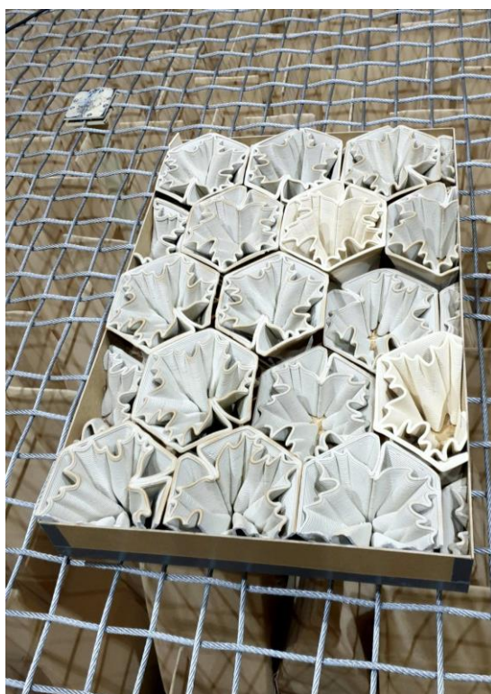
FOTO. Powtarzający się motyw liścia klonu o różnych wysokościach badany w komorze bezechowej
