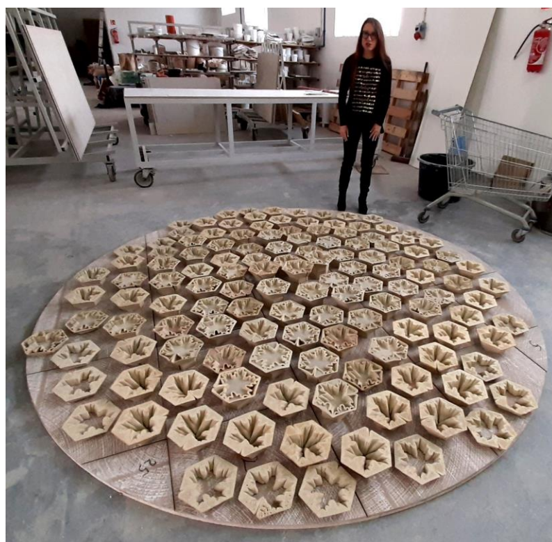
FOTO. Ustrój akustyczny rozpraszający z motywem liścia klonu o wysokości od 4 cm do 18 cm półką poziomą i bez.
