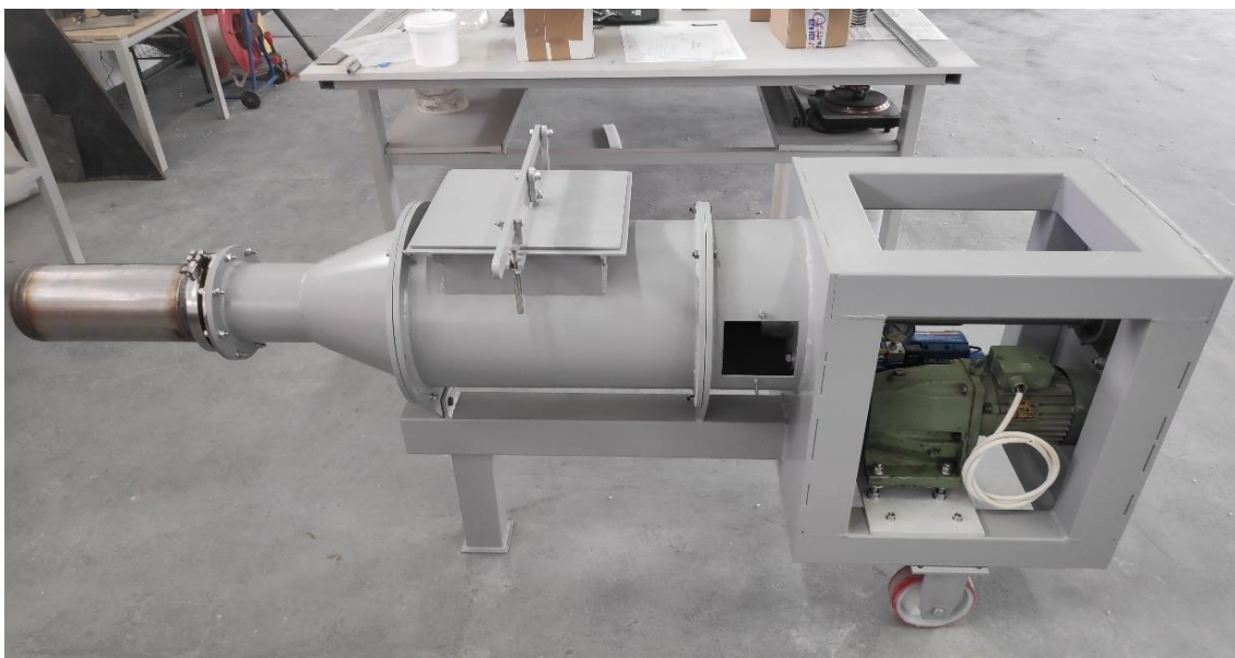
FOTO. Mieszalnik z funkcją odpowietrzania masy i systemem dokującym kasety z masą do druku 3d.
