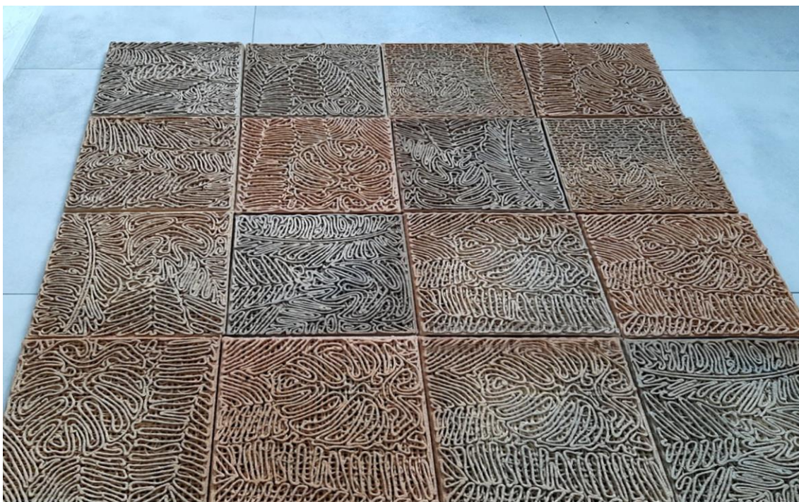
FOTO. Gotowa elewacja po wypale w t=1300^{\circ}\text{C} .
