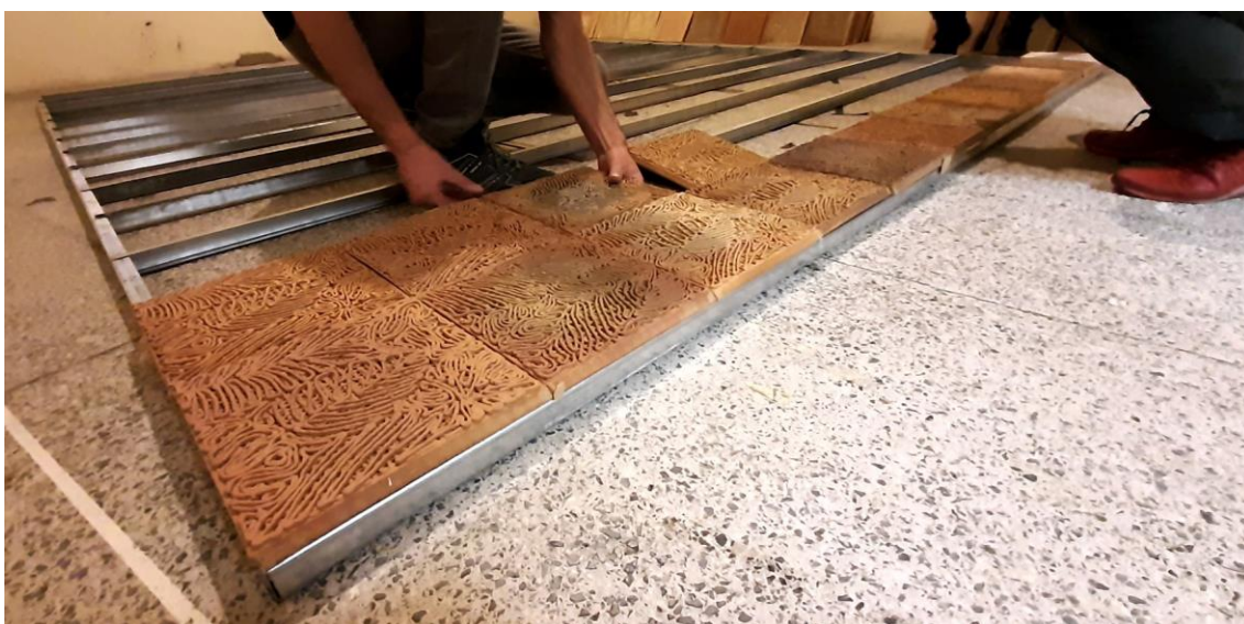
FOTO. Badanie systemu elewacyjnego w komorze pogłosowej. Grubość urządzenia akustycznego 2 cm.
