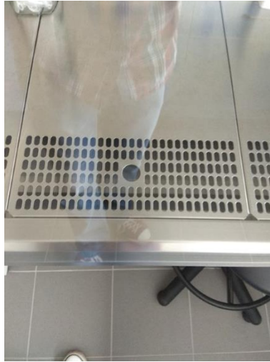
Fot. 6 Element blatu roboczego z otworem ułatwiający wyjmowanie i wkładanie w komorze Thermo Sci MSC Advantage
