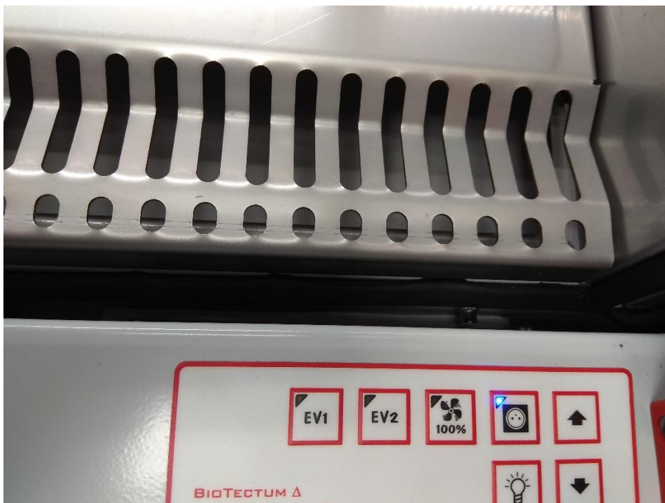
Fot. 7 Szczelina między blatem komory a obudową
