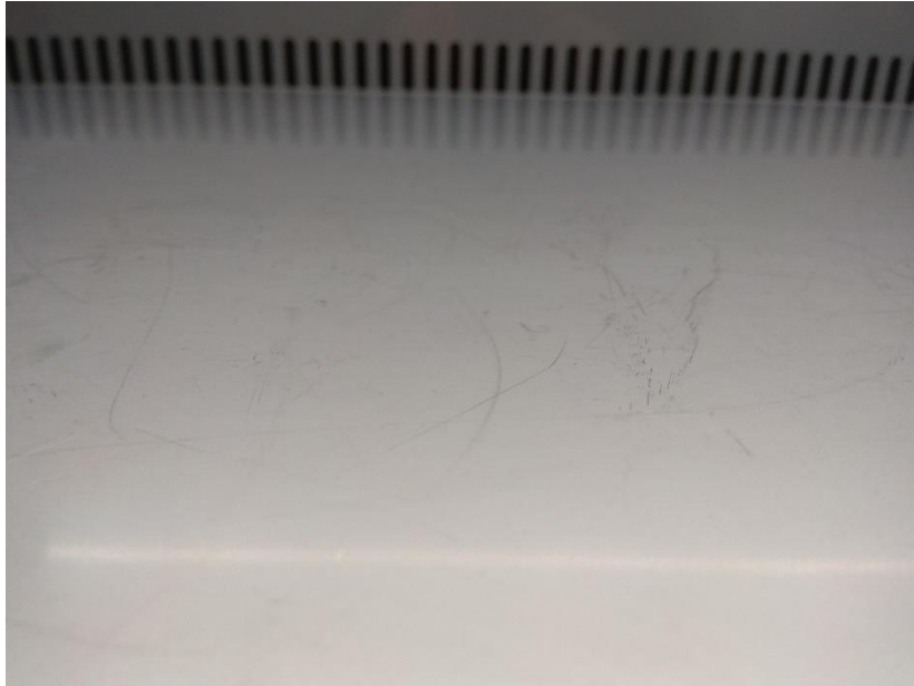
Fot. 9 Zarysowania na blacie roboczym
