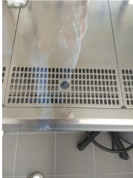
Fot. 4 Element blatu roboczego z otworem ułatwiający wyjmowanie i wkładanie w komorze Thermo Sci MSC Advantage
