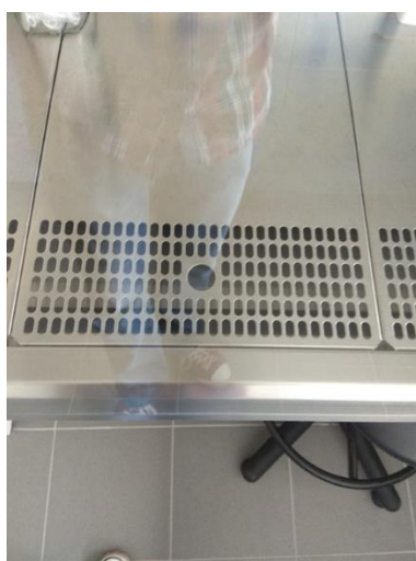
Fot. 2 Element blatu roboczego z otworem ułatwiający wyjmowanie i wkładanie w komorze Thermo Sci MSC Advantage
