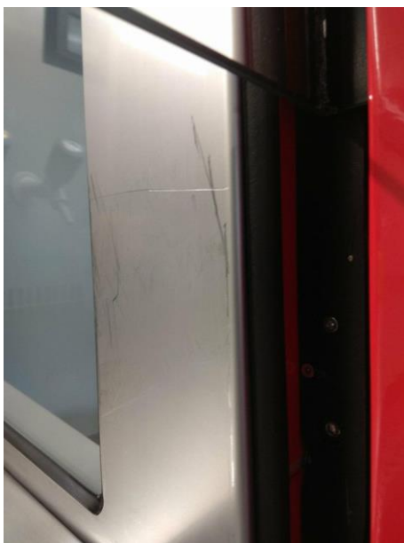
Fot. 1 Zarysowane elementy obudowy przez blat roboczy
