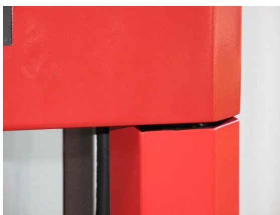
Fot. 2 Niespasowane elementy obudowy komory
