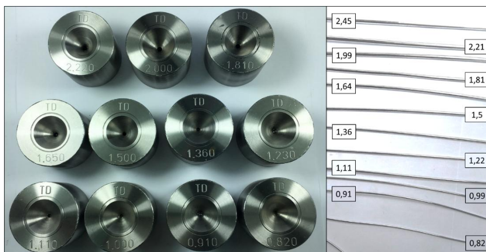
Rys.3.8. Zdjęcie ciągnadeł oraz drutów ze stopu aluminium AlMg5 poddanych procesowi ciągnięcia
