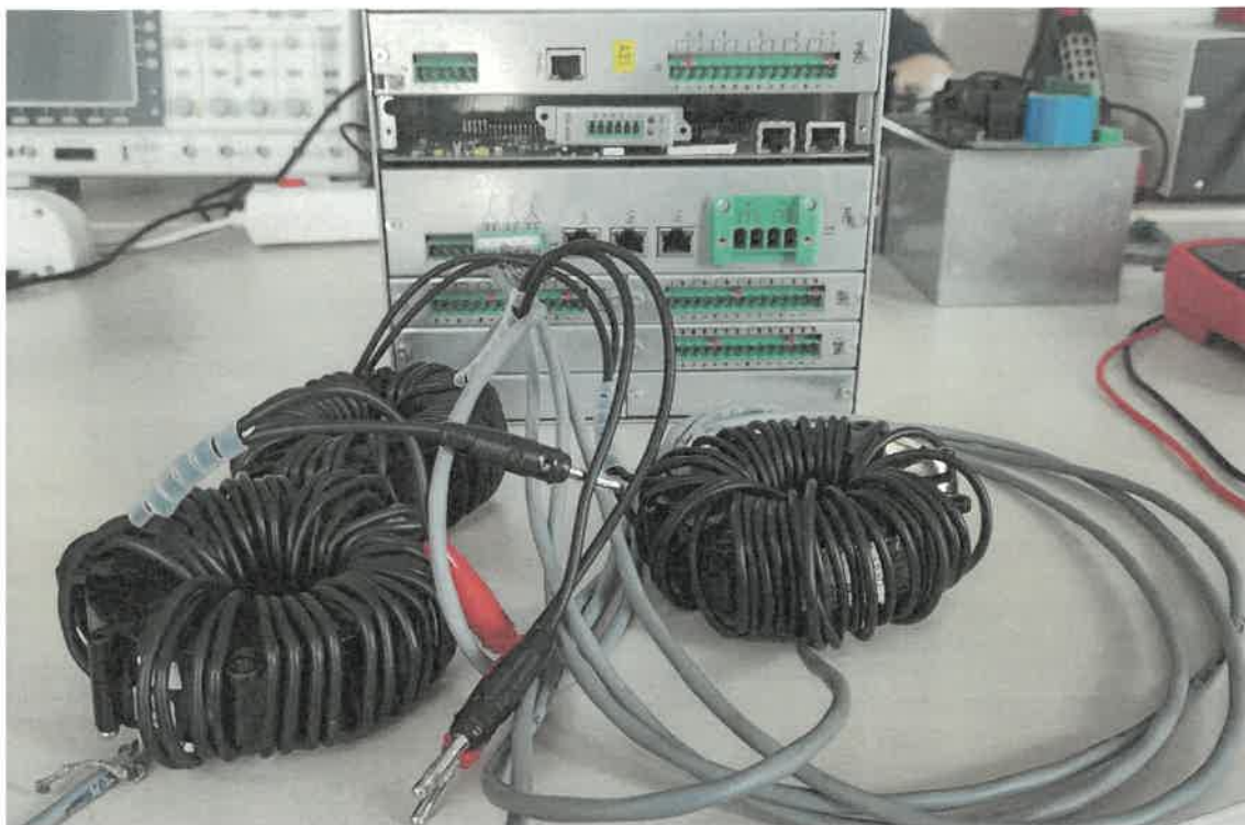
Fot. 2. Opracowana karta RC z podłączonymi sensorami prądowymi, sterownik polowy e 2 TANGO-800
