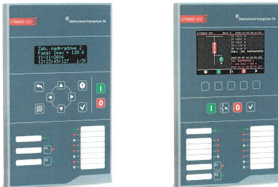
Fot. 3. Widok opracowanych w ramach prac rozwojowych prototypów zabezpieczeń e 2 TANGO-250 i 450
