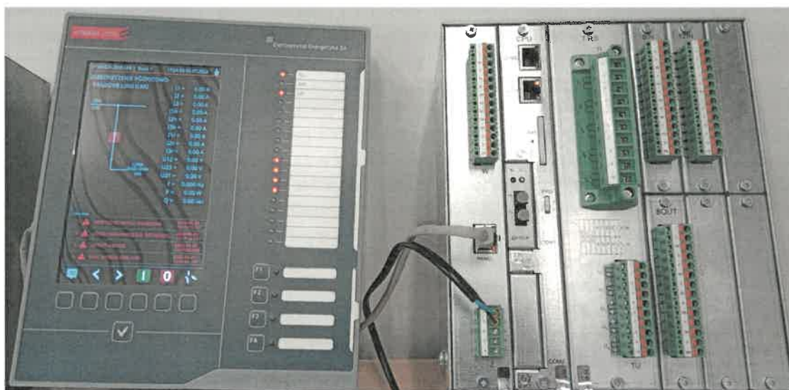
Fot. 1. Widok opracowanego w ramach prac rozwojowych prototypu zabezpieczenia linii wysokiego napięcia typu e 2 TANGO-2000
