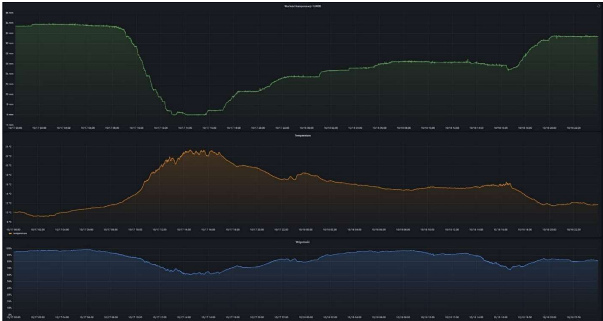
Rys.153 Monitorowanie sieci – czujniki parametry wartość kompensacji, temperatura, wilgotność po 2 dniach, źródło: MABO
